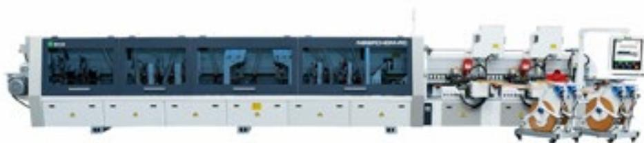
ПК управление Прифуговка 1-й подогрев торца детали 1-й клеевой узел 1-й магазин подачи кромки 1-я пресс-группа 2-й подогрев торца детали 2-й клеевой узел 2-й магазин подачи кромки 2-я пресс-группа
