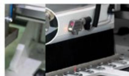
Датчик контроля толщины детали
