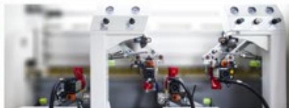
Высокоскоростной узел обкатки углов
