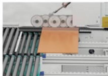
Усиленные роликовые автоподатчика
